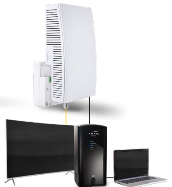
Als Abschlusspunkt für Aktiv Ethernet/GPON/XGSPON (NE 2 „2 Box-Lösung“)
